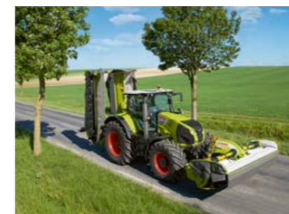
Position de transport compacte, gage de sécurité sur la route.
