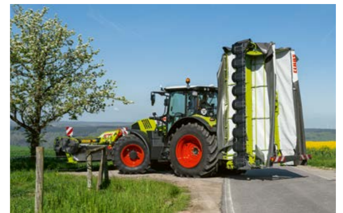
Moins de 4 m de haut et une ligne compacte, comme toutes les DISCO : avant de replier les deux unités de fauche, il suffit de rentrer les bras télescopiques.
