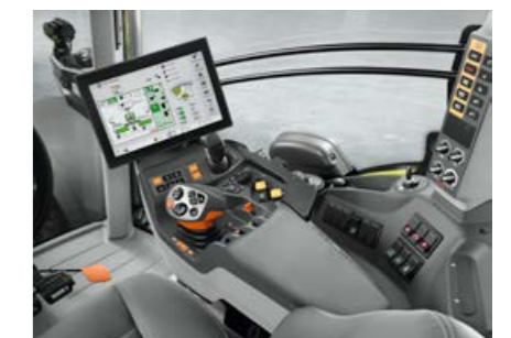
Si le tracteur est équipé d'un terminal compatible ISOBUS, la commande de présélection du CONTOUR peut s'effectuer directement via celui-ci.
