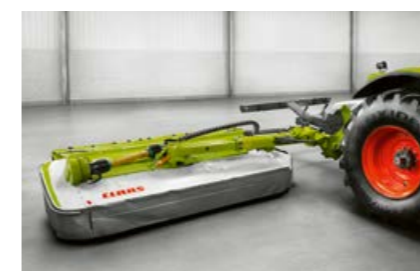
Avec les bras télescopiques hydrauliques, la largeur de coupe varie entre 9,40 m et 10,70 m selon la faucheuse frontale.
