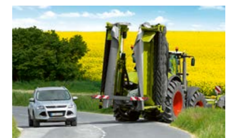
Moins de 4 m de hauteur : encombrement réduit en position de transport, avec une garde au sol généreuse sur les deux modèles BUSINESS.
