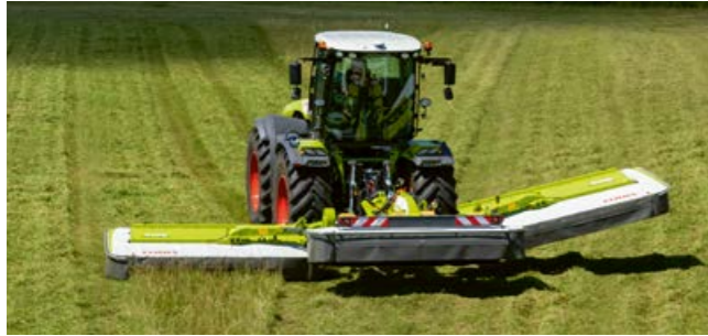
Relevage individuel des unités de fauche en fourrière.
