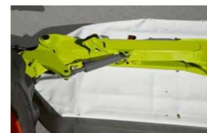
Machine protégée par la protection anticollision hydraulique non-stop en cas de choc – l'unité de fauche pivote et se remet automatiquement dans la position initiale.
